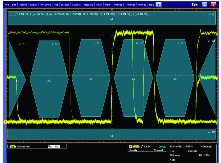
부울린(Boolean) 로직 트리거 자격. 로직 OR을 사용한 부울린(Boolean) 로직을 통해 사용자는 각 비트를 동시에 모니터링하고 획득의 모든 포인트에서 발생한 이상을 캡처할 수 있습니다.
